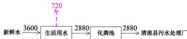
图 2-6 项目水平衡图 单位：t/a
