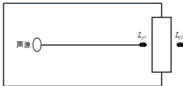
图 4-1 室内声源计算示意图
